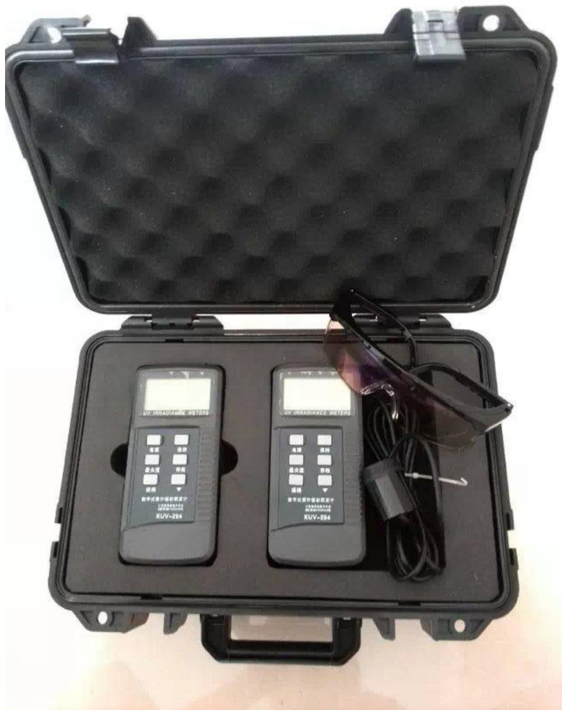
KUV-254 无线远程数字式紫外辐射照度计 ---(避免现场紫外线因防护不周时对监测人员造成的伤害。)
