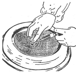
1、将试样进行粗磨磨料
