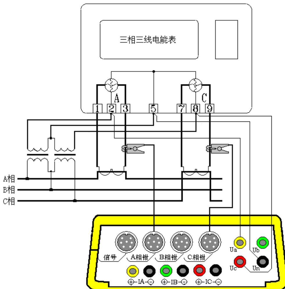
三相三线高压表计经钳表接入接线
