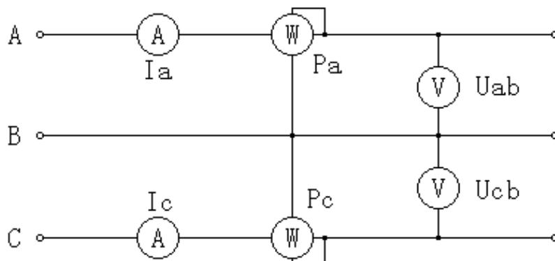
图十六、三相三线制测量原理图
