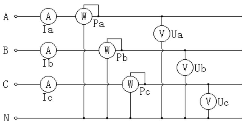
图十七、三相四线制测量原理图
