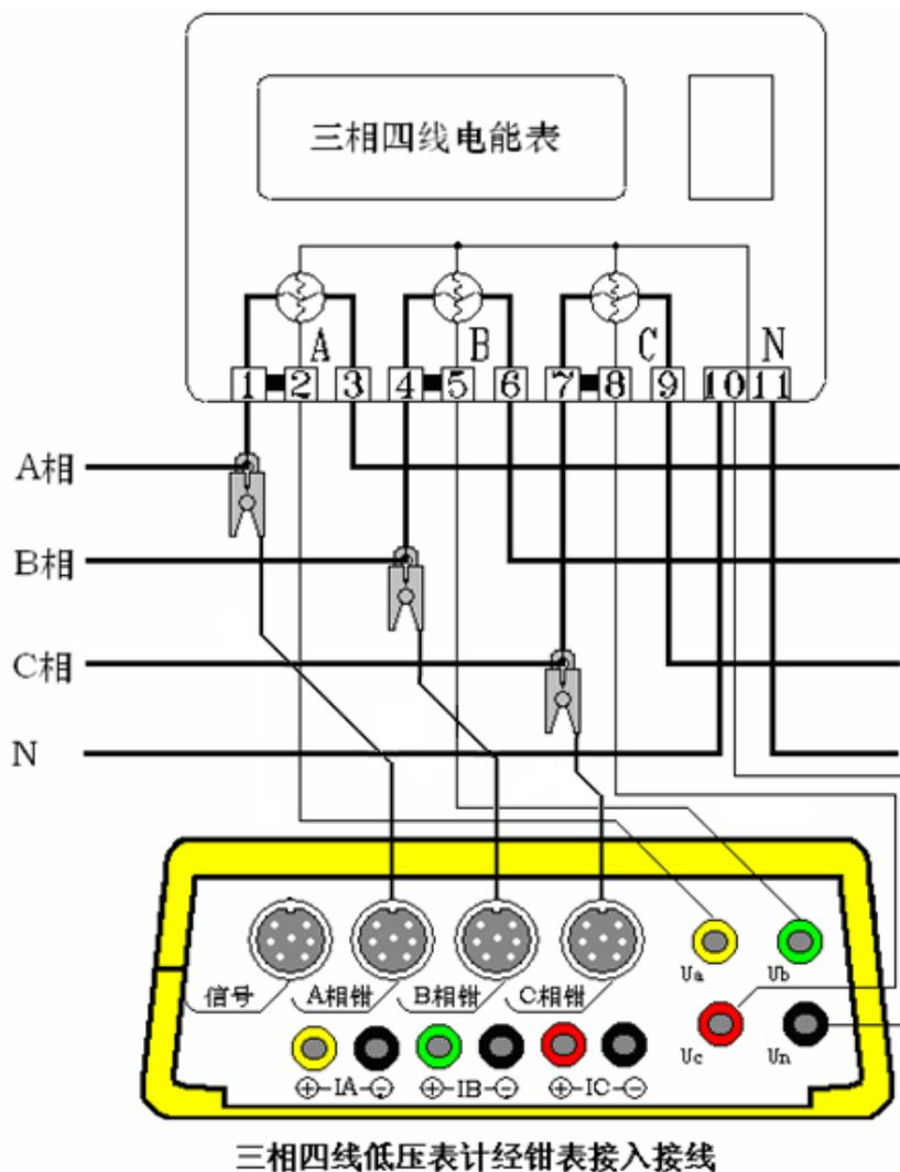
三相四线低压表计经钳表接入接线
