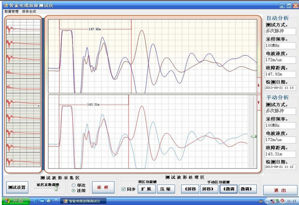
图 18 仪器在多次脉冲法时故障点在终端或终端模拟故障的测试波形
