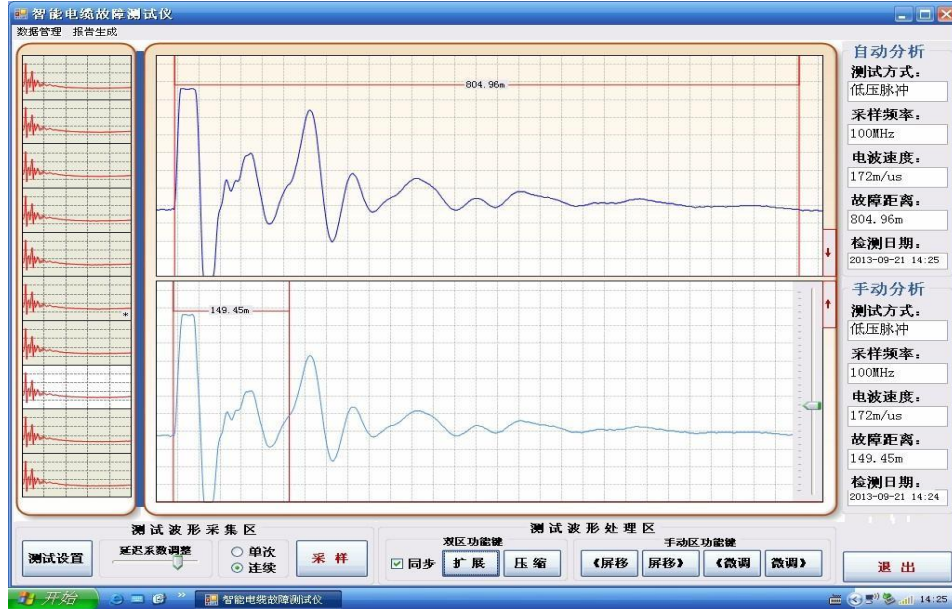
图 9 为主机连接多次脉冲产生器采集低压脉冲电缆波形
