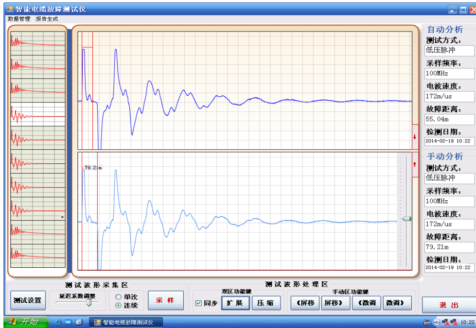
图 11 低压脉冲法测得短路故障或低阻故障波形
