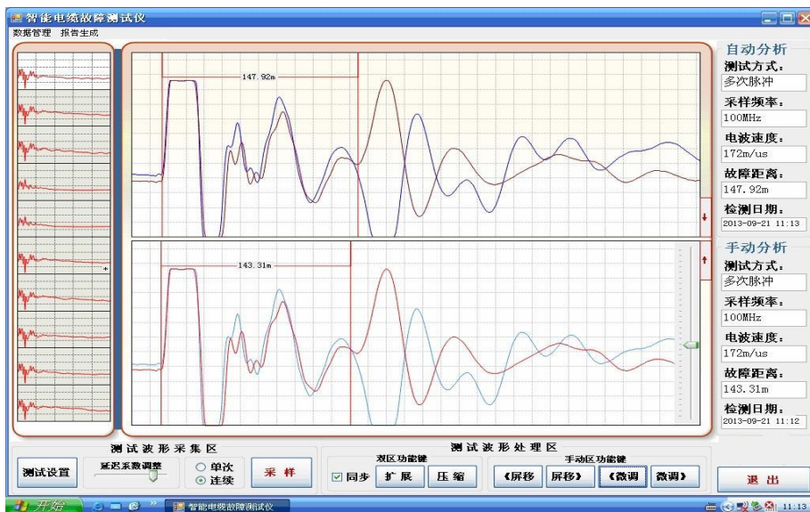
图 15 仪器在多次脉冲法时扩展的多次脉冲波形
