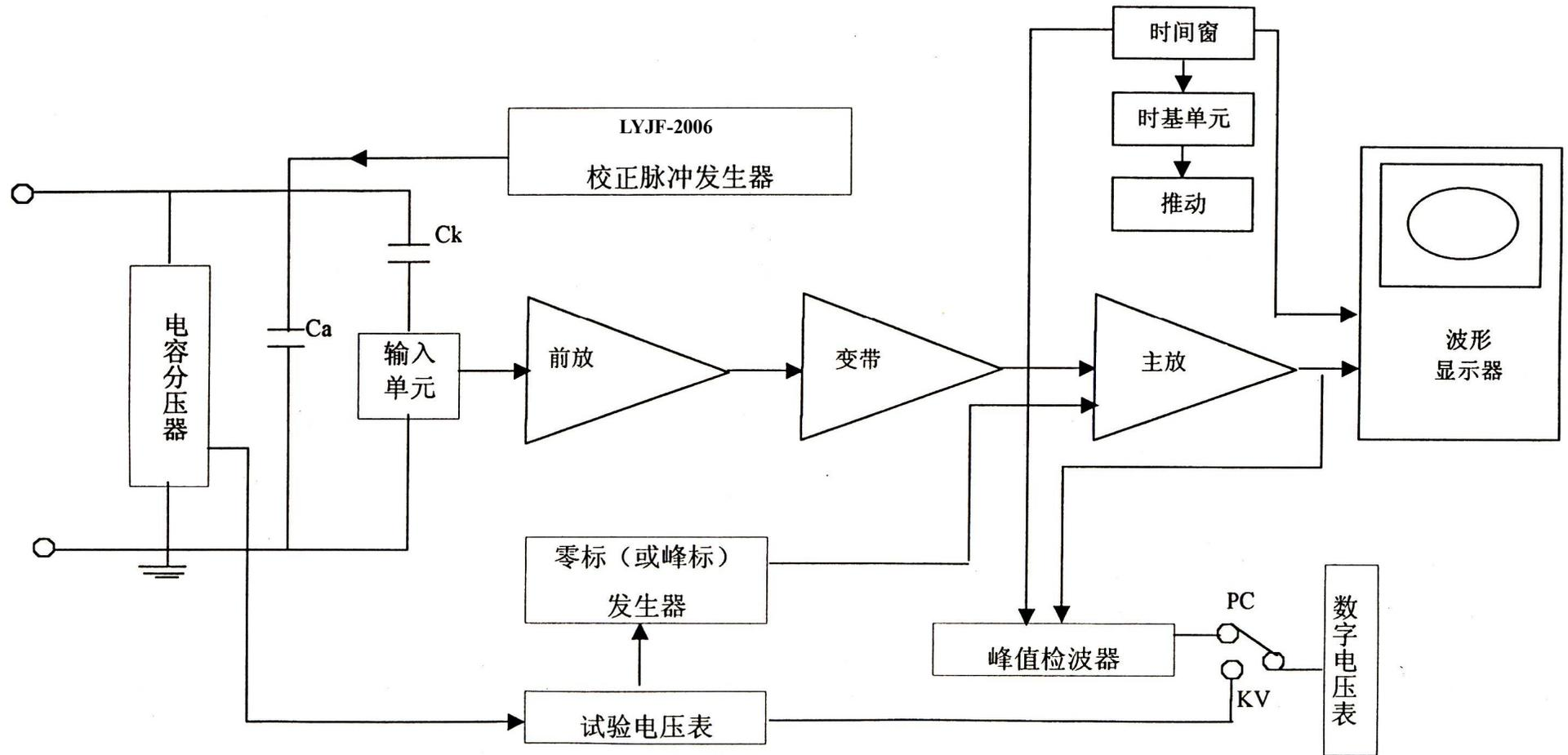
图一 局部放电检测仪
