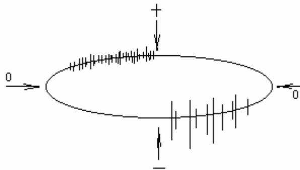
如果随试验电压升高,放电幅值也增大,而且放电波形变得模糊,则往往是含有不同大小多个气泡,或是外露的金属与介质表面之间出现的表面放电。(图 5—03)
