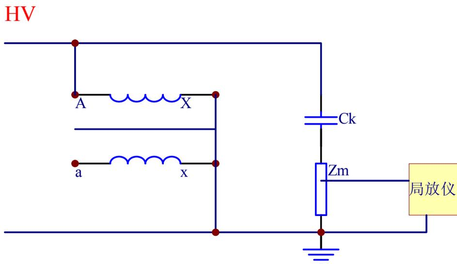
B. 高频加压方式接线原理图
