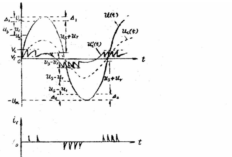
图 1—2 介质内单个气泡在交流电压下的局部放电过程
