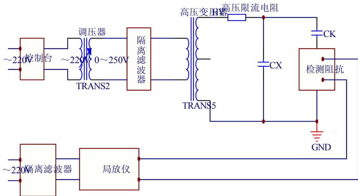
根据上述原理图可以看出，局部放电测试的灵敏度和准确度和整个系统密切相关，要想顺利和准确的进行局部放电测试，就必须将整个系统考虑周到，包括系统的参数选取和连接方式。另外，在现场试验时，由于是验证性试验，高压限流电阻可以省掉。
