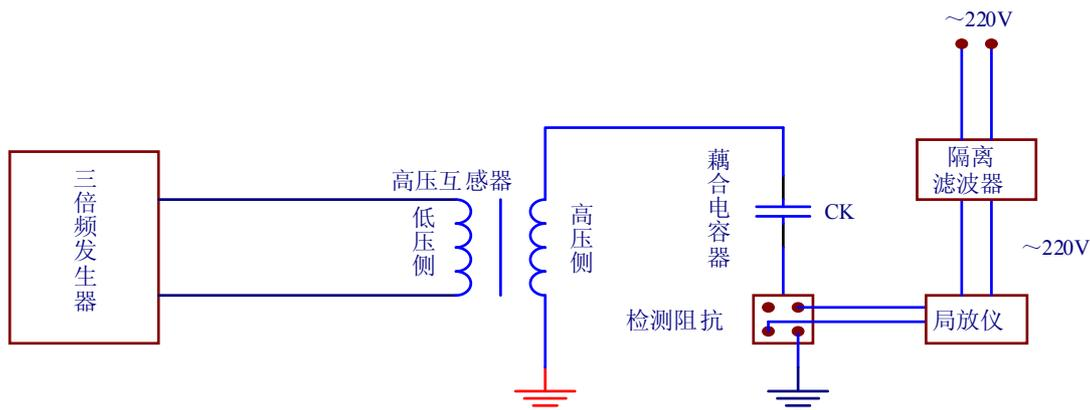
(3) 高压电容器. 绝缘子的局放测试接线原理图
