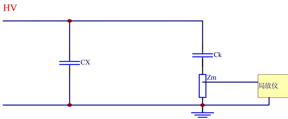
(4) 发电机的局放测试接线原理图
