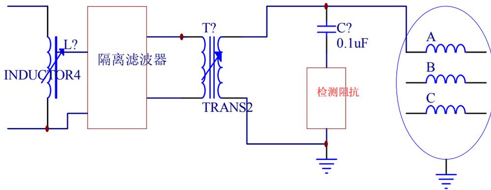
(5) 变压器的局部放电测试接线原理图
