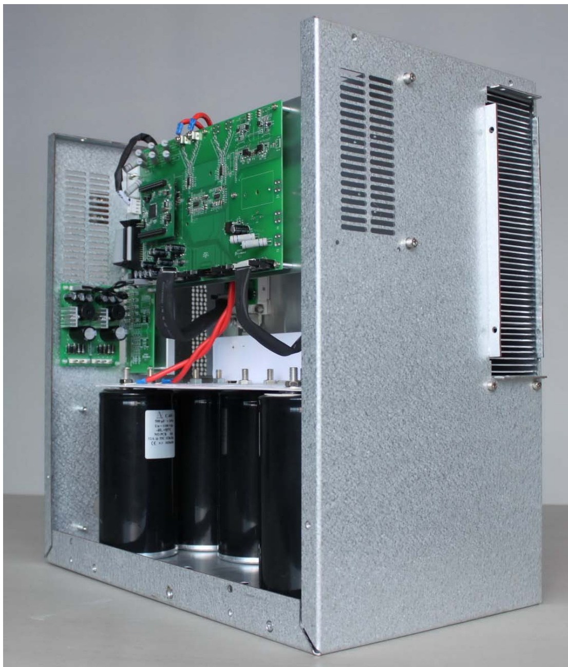
图表 5 单个功率模块实物图
