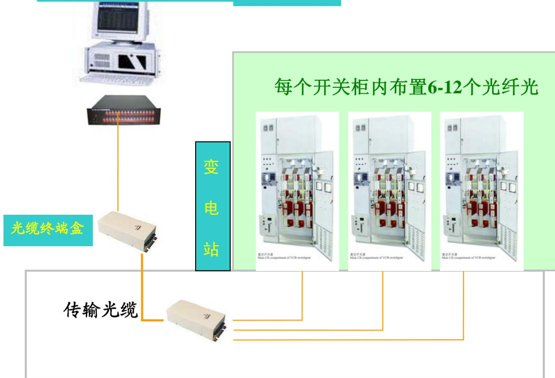
图十二、高压开关柜在线监测图
