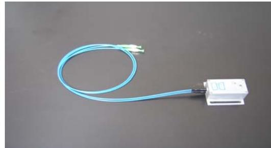
图五、光纤微震传感器
