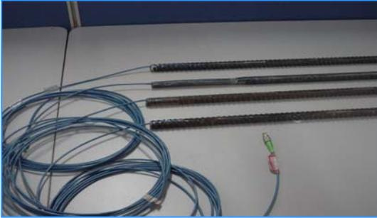
图二、光纤锚杆应力计
