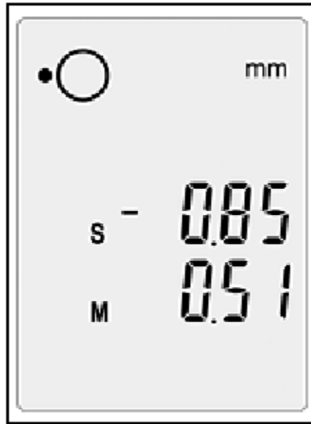
图.16. 显示单元提示您将测量单元置于 9 点位置
