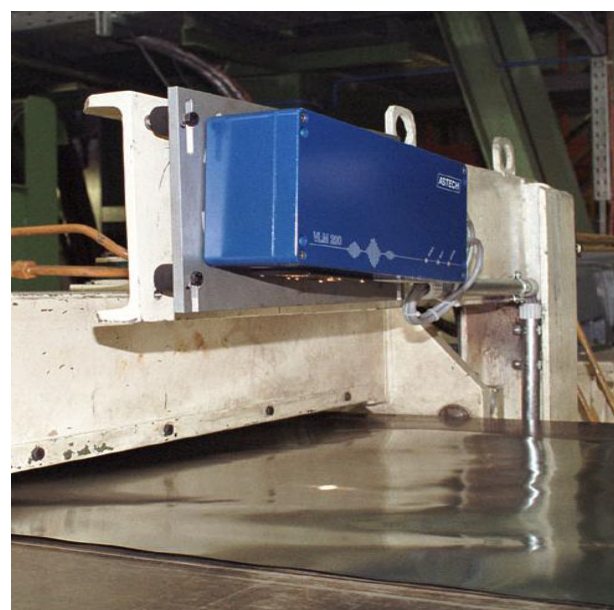
白光测速仪在精整线上的应用：延伸率测量
