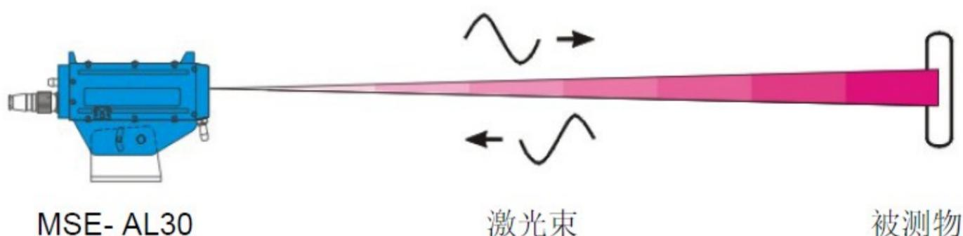
MSE-AL30型激光铝水液位计采用相位比较原理进行测量。激光传感器发射不同频率的可见激光束，接收从被测物返回的散射激光，将接收到的激光信号与参考信号进行比较，最后用微处理器计算出相应相位偏移所对应的物体间距离。测量精度可以达到mm级。
