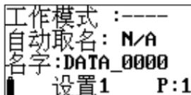
“工作模式”：仪器功能强，有较多参数可以设置，按标准要求不同、测量目的不同，提前将这些参数设置好，并分成多个组，对不同的组可以取上不同的名称，这就是组合参数，也叫工作模式。用户只需按测量的要求调用不同的参数组而无需每个参数去设置，这样可以方便用户使用。当仪器内部没有保存正确的组合参数时，其后显示“----”，可以用计算机将新的组合参数写到仪器内，仪器内最多可以保存 32 组组合参数。用计算机将新的组合参数写到仪器内的操作可以参考《随机软件使用说明》。
