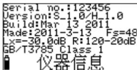
第一行为仪器的机号；第二行为仪器软件及硬件的版本；第三行为软件的生产日期；第四行为仪器的生产日期及仪器的采样频率；第五行为传声器的灵敏度级及测量范围；第六行为符合的标准。
