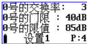
图 5 设置 0 号声暴露计
