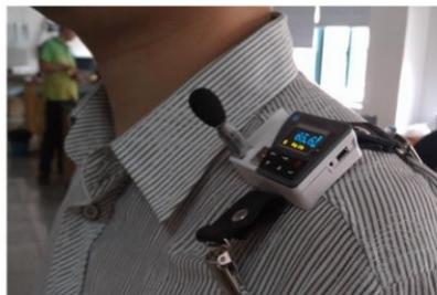
5、测量结束后，拆下时应先将卡扣张开后取下，不可以直接拉下。
