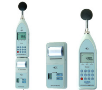
HS6288B 噪声频谱分析仪 HS6288E 多功能噪声分析仪
