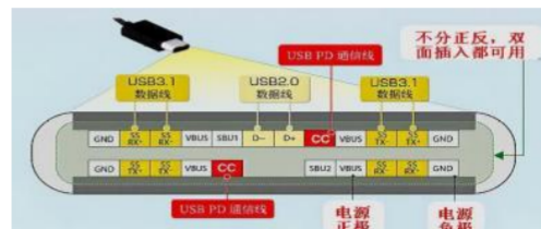
图 4-4 USB-Type-C_16 母座
