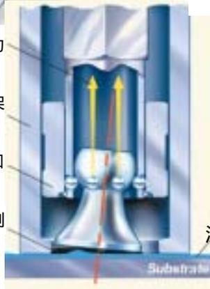
拉拔式附着力测试仪自动对准补偿。一个经常用的环形轴承卡住捣锤的球形头保证对准。只有这款拉拔式附着力测试仪有这个特性。
