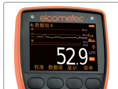
屏幕趋势图显示最后20个测量值
