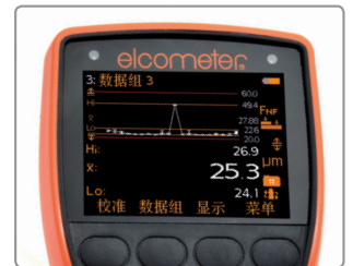
趋势图显示每次扫描的平均，最高，最低厚度读数
