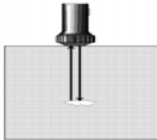
图 1.1 超声探伤基本工作原理
