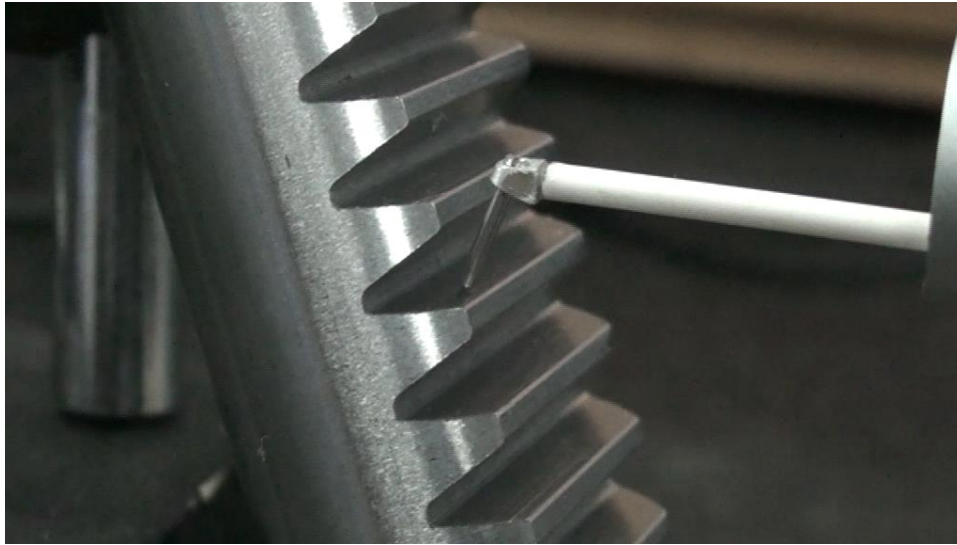
(120°角传感器) 狭窄齿面测量 (φ1.3mm传感器)
