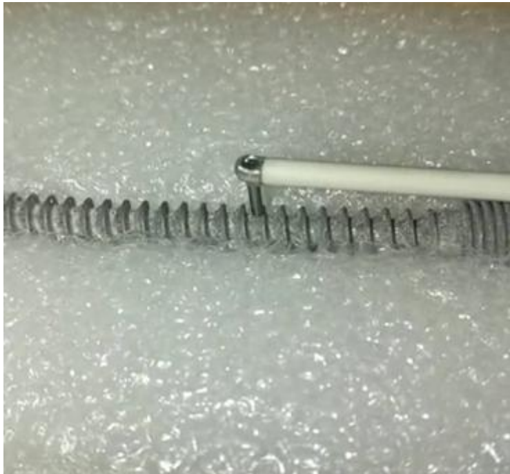
直径 2 毫米的螺纹粗糙度测量
