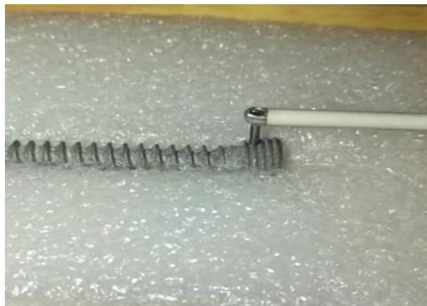
直径2毫米的螺纹粗糙度测量
