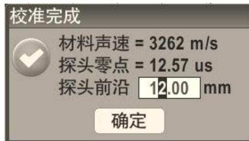
第 5 步：选择“校准角度”，按“OK”键，然后输入“探测范围”，“测孔深度”和“测孔直径”。CSK-1A 标准试块的孔径为  $\Phi 50$ ，孔中心离探测面的垂直距离为 30mm，按“OK”键进入下一步
