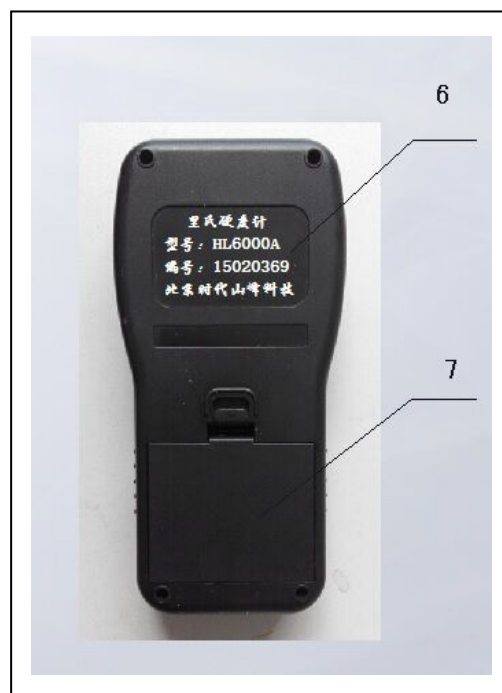
1 外壳 2 通信插座 (RS232) 3 冲击装置插座 4 液晶显示屏 5 键盘 6 铭牌 7 电池仓盖
