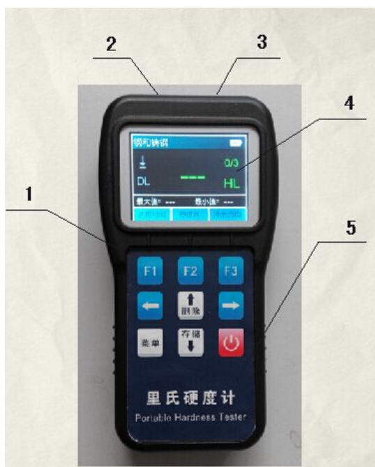
1 外壳 2 通信插座 (RS232) 3 冲击装置插座 4 液晶显示屏 5 键盘 6 铭牌 7 电池仓盖
