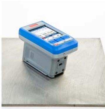
按压显示控制单元的开关/测量键，完成一次测量。
