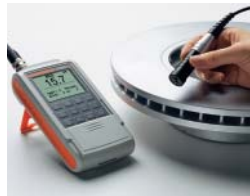
DELTASCOPE® FMP30 配合双触点探头V7FKB4 - 测量卡车刹车盘
