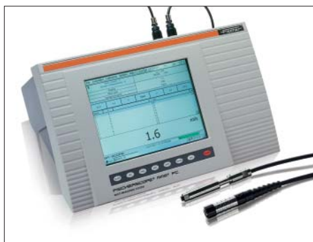
FISCHERSCOPE® MMS® PC, 集成了磁感应法、涡流法和BETA背反射法的多功能测量系统, 用于测量镀层厚度和材料测试。
