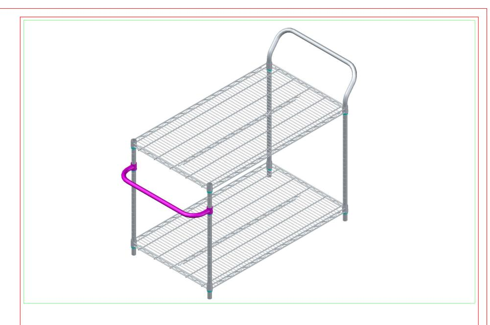
第四步: 整体货架安装完毕,小锤轻击,使整个货架更加牢固
