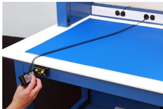
检测接地端子接地电阻示例
