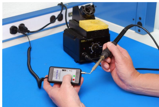
检测设备接地电阻示例
