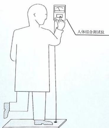
图49 采用人体综合测试仪进行人/鞋系统电阻测试示意图
