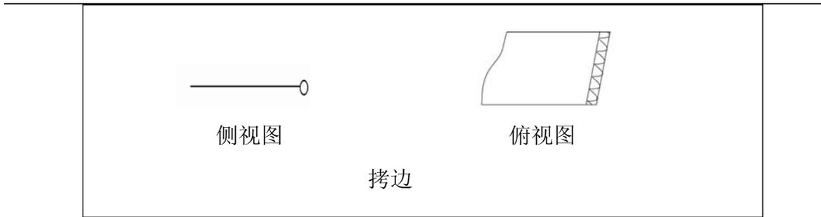
图1 边缝的缝制方法
