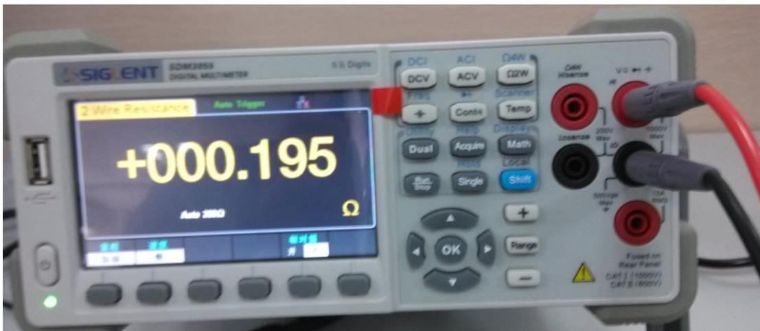
图 3 基于鼎阳科技台式万用表 SDM3055 二线制测量结果
