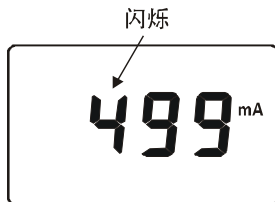
图14. 电流报警临界值设定
