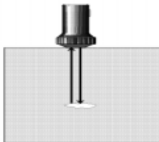
图 1.1 超声探伤基本工作原理
