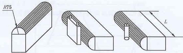
图 1 单体挤压板和挤压示意图
