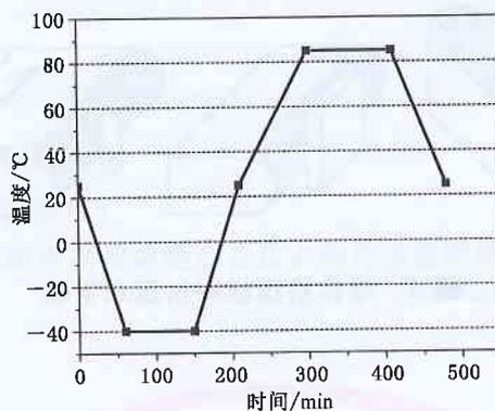
图 2 温度循环试验示意图
