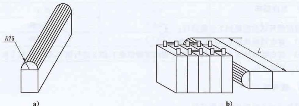
图 3 模块挤压板和挤压示意图
