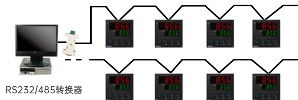
注:连线方式:每条线路可连50-60台仪表，必须采用RS485 通讯专用双绞线或计算机连网用的五类线(用其中对即可)
