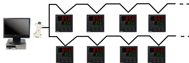
注:此图为错误的连接方式，此类星型接点会导致通讯网阻抗不匹配，缩短通讯距离
