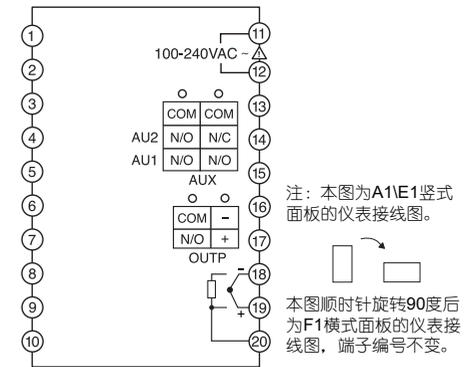
D 型面板仪表 (72mmX72mm) 接线图如下:
