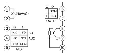
注 1: 热电偶应用补偿导线直接接入仪表后盖输入端子上, 中间不得转用普通导线连接, 并注意补偿导线型号与极性的正确。
