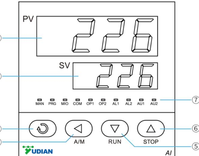
仪表上电后进入基本显示状态，此时仪表上、下显示窗分别显示测量值 (PV) 和给定值 (SV)，下显示窗还可交替显示以下字符表示状态：① “orAL”，表示输入的测量信号超出量程；② “HIAL”、“LoAL”、“HdAL”或“LdAL”时，分别表示发生了上限报警、下限报警、偏差上限报警、偏差下限报警；③ “StoP” 表示处于停止状态。
