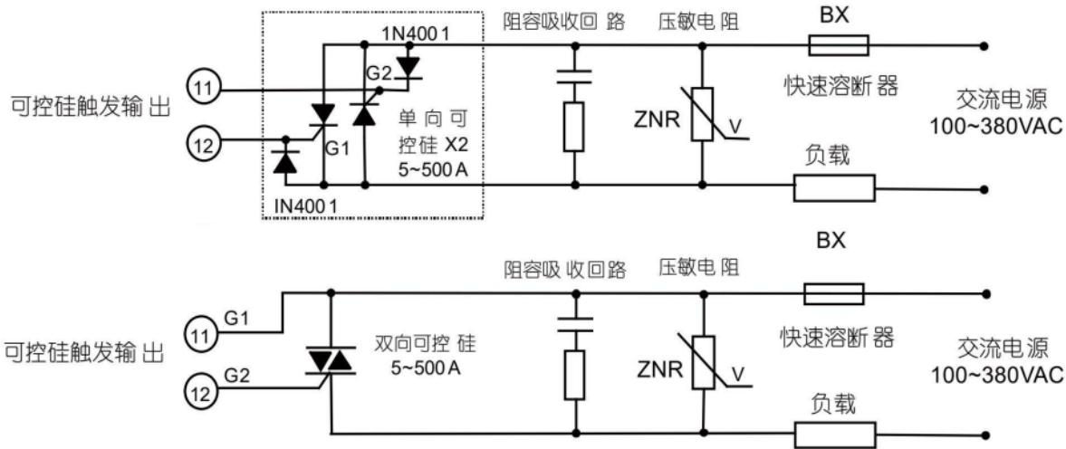
注1：根据负载的电压及电流大小选择压敏电阻以保护可控硅，负载为感性或采用移相触发时必须加阻容吸收。
