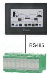
作为无纸记录仪和触摸屏控制系统的下位机使用
