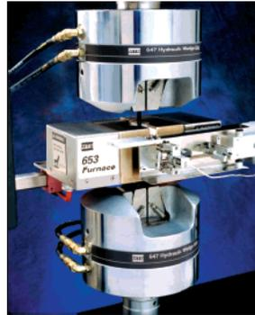
无论是标准试验还是特殊要求的试验，都可以在HT-9711材料试验系统上配置夹头，夹具，引伸仪，高温炉，力传感器以及其它环境控制和感应设备等各类附件，HUNGTA根据用户的试验要求为您选配这些附件。
