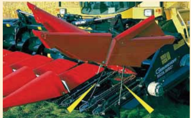
提高保护：工业气弹簧保护重盖子。
