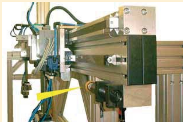
ACE 工业油压缓冲器应用在龙门机床上
