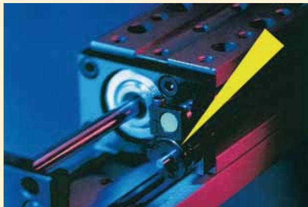
应用在线性气动模块中的小型缓冲器
