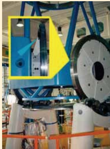
精密望远镜使缓冲器实现完善的过冲保护
