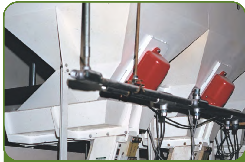
Syntron® V-20电磁式仓壁振动器在料箱与包装线之间保持面糊的流动
