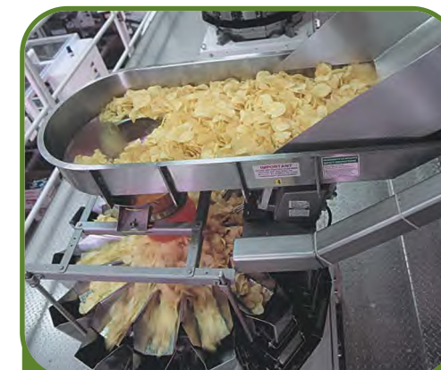
Syntron® BF-2给料机用于食品包装行业将薯片均匀分送到多头称包装。
