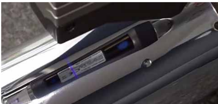
使用LineScan2-8进行镜面工件的测量案例
