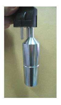
其中 a 尺寸为 4.6±0.05mm, 总重为 400g(由两个 200g 重的砝码组成), 在进行地线孔的 5000 次正常插拔之前,需用总重 400g 的规插入地线孔垂直 向下 30s 需不能脱落,在插拔试验之后,需再用此规进行 30s 最小保持力测 试,但重量需用 200g.
