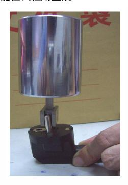
试样如图所示,在两个插销之间放一分钟时间. 试样不允许因自身重力作用与插头正面接触.
