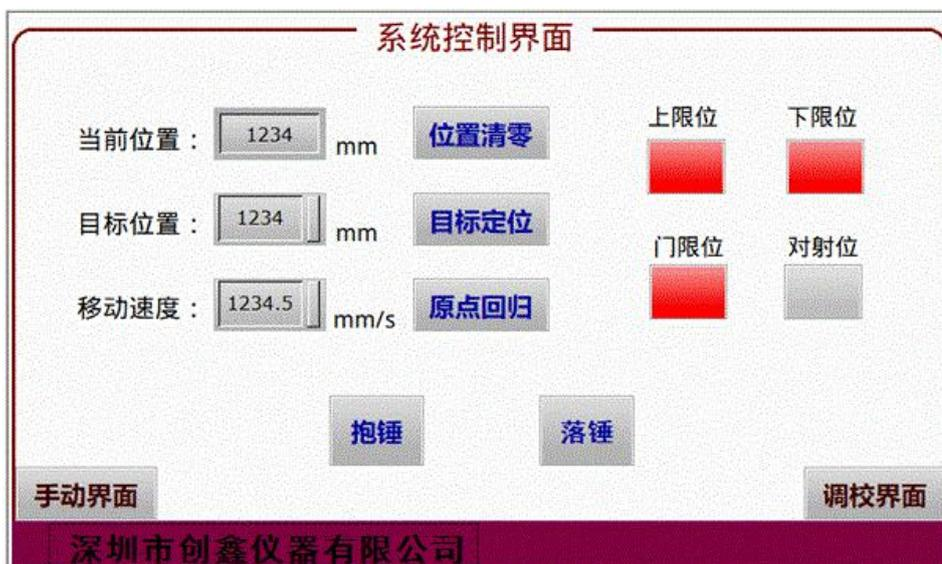
“目标位置”，是用来设定试验高度，点设定高度输入框进入设定高度界面。
