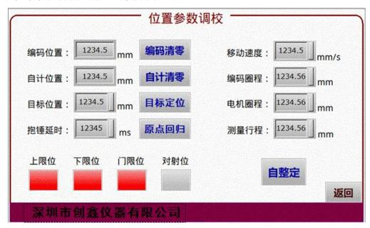
通过修改"电机圈程"和"编码器圈程"的大小可以标定位移。
