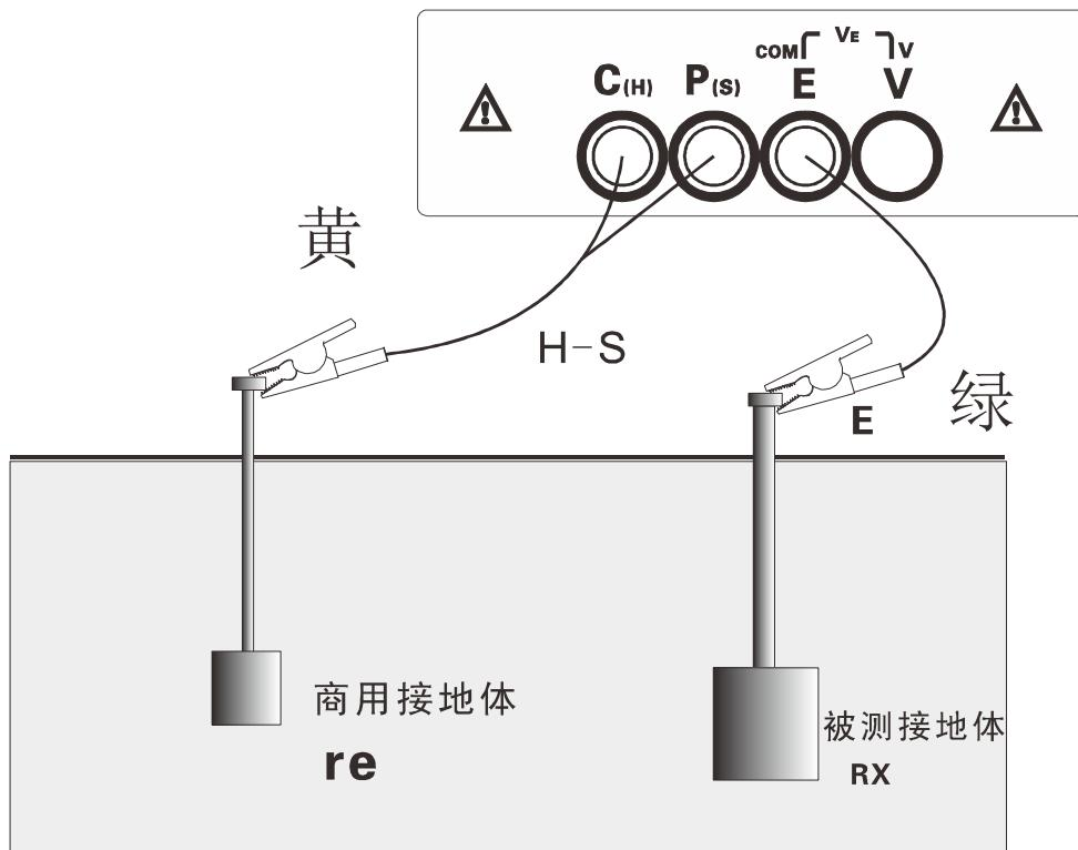
简易法测量接地电阻，其仪表读数为被测接地体的接地电阻值与商用接地体的接地电阻值之和，即：
