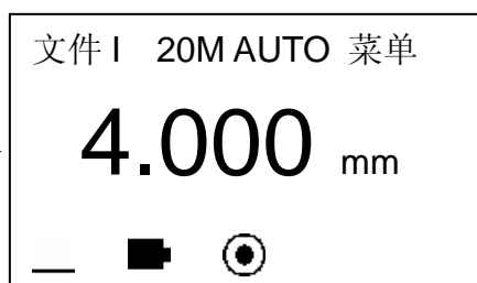
图 12 探头离开被测材料
