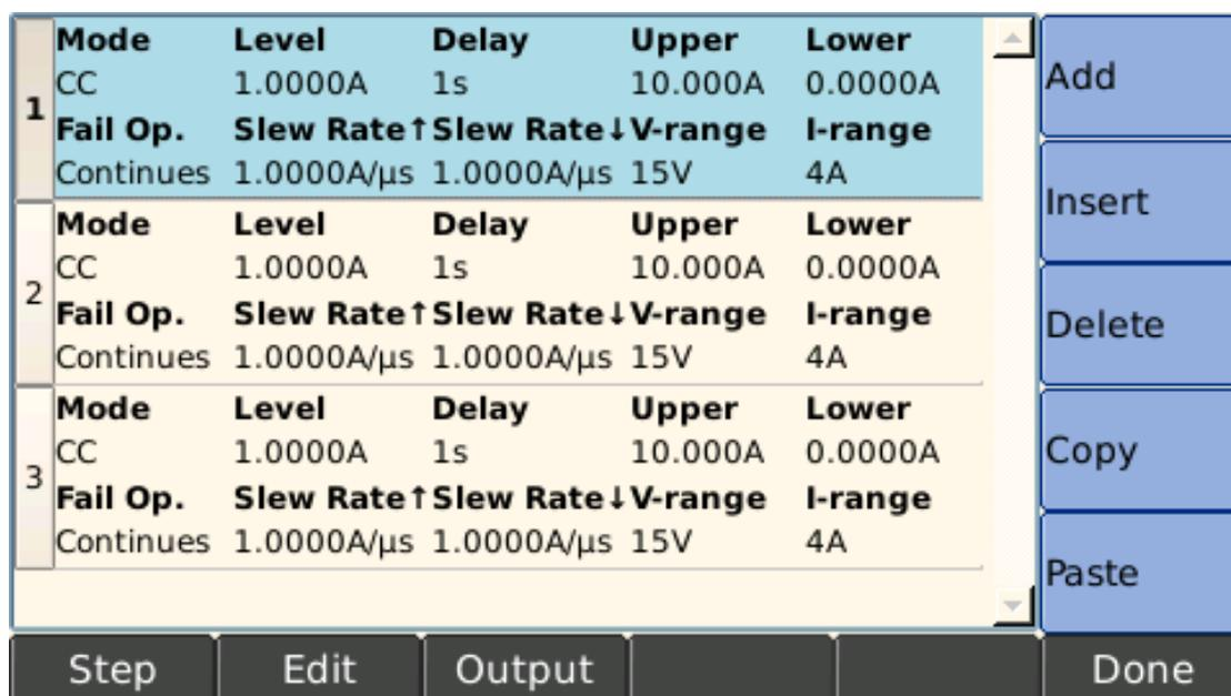
自动测试功能被用于生产线的产品检验，负载按照文件中编辑的步骤，按顺序进行带载及测试，自动判断合格与否，并根据设置的触发条件，启动触发输出。
