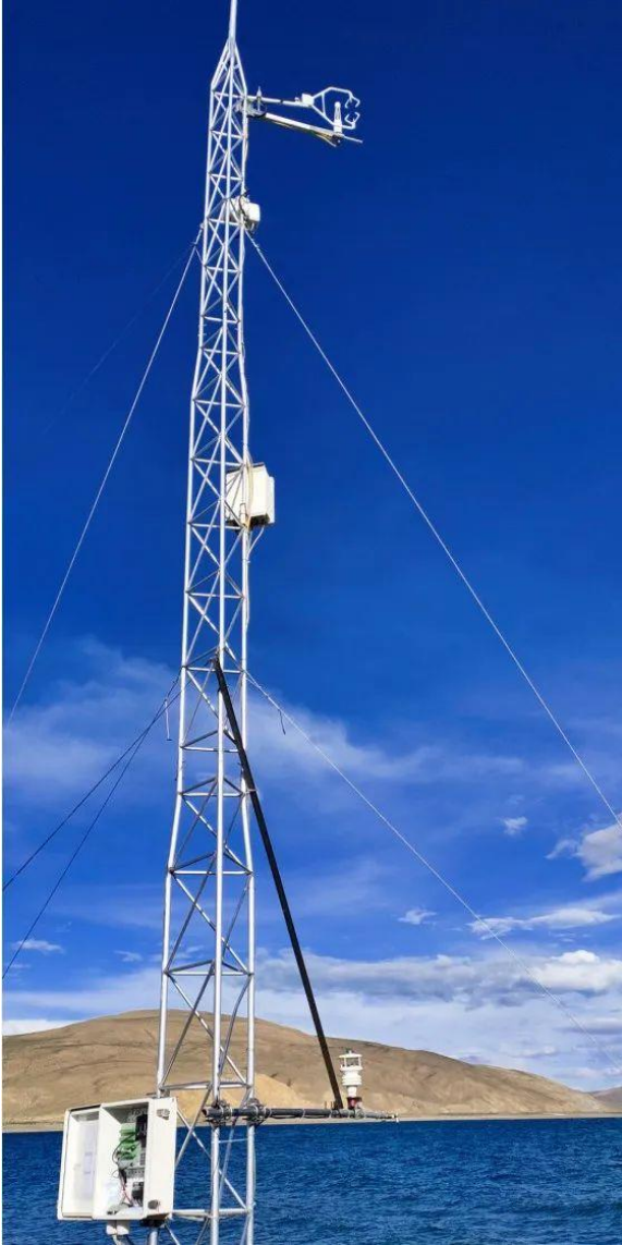
在普兰县的拉昂措安装了10米涡动观测系统
