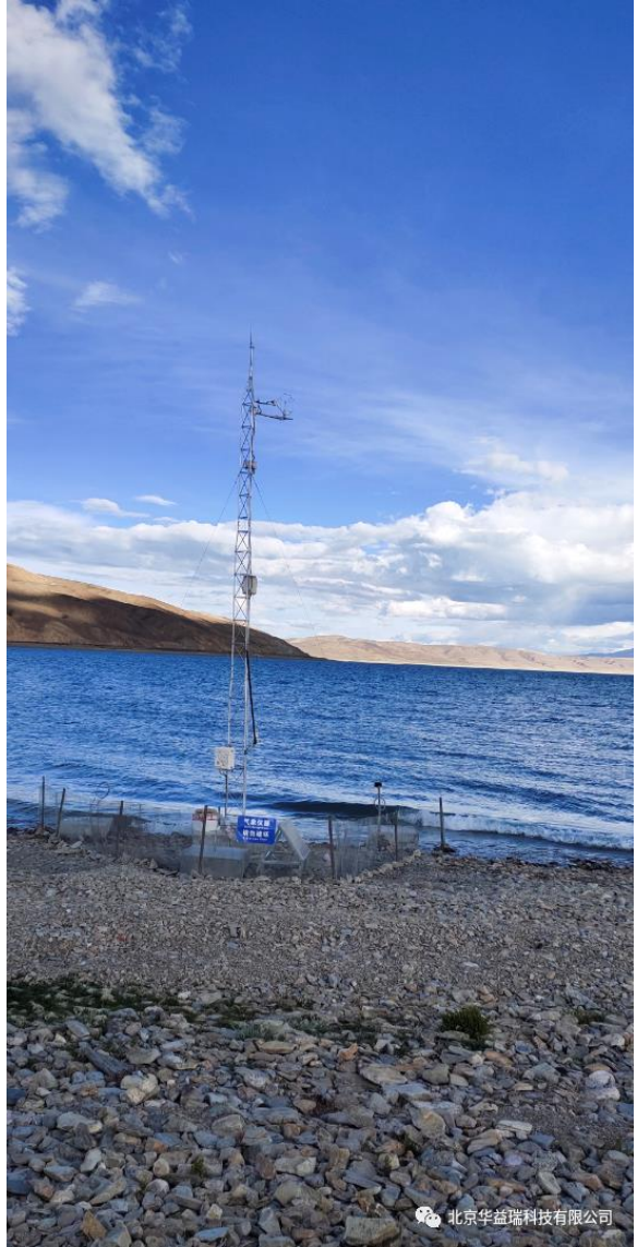
在普兰县的拉昂措安装了10米涡动观测系统
