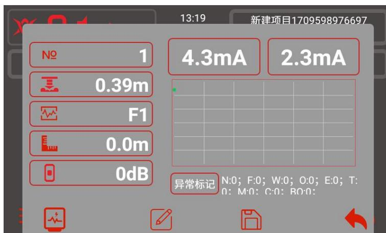
当待测管道周围没有其他金属干扰时，实时测量深度即为管线真实深度，当待测管道周围存在金属干扰时，测量深度可能会出现误差。
