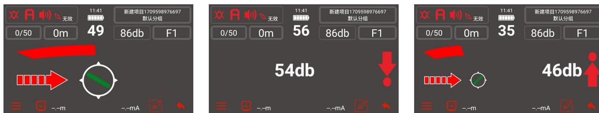
左上角的图标包含：天线模式、A 字架、声音、GNSS 卫星定位
