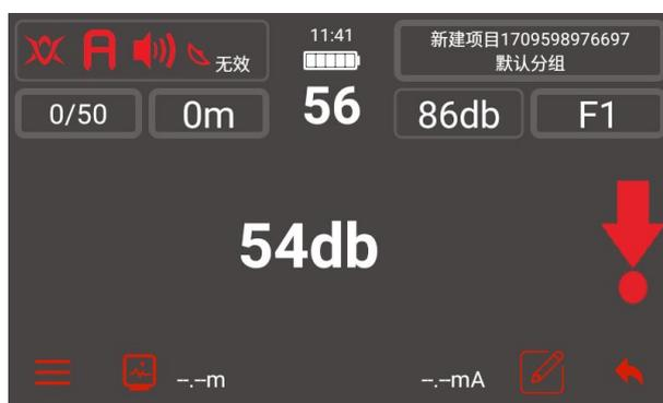
沿着管道一直走，当出现箭头方向改变时，说明故障点就在附近，以 1m 间距来回测量，当这次测量箭头和下次测量箭头正好相反时，这个位置就是绝缘故障点。
