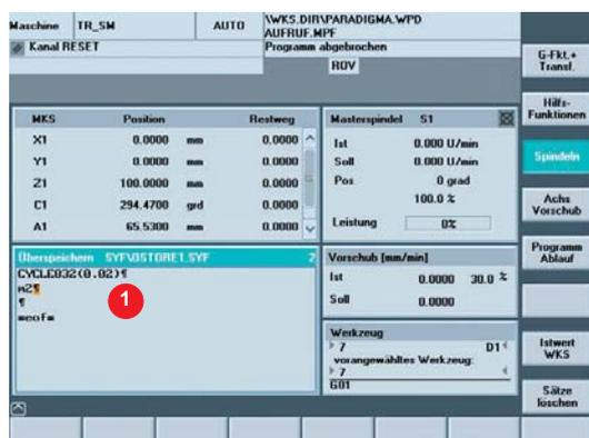
此处所示的是一个典型示例，在该示例中需要更改压缩机公差。已调用 CYCLE832 并将压缩机公差手动更改至 20 μm ❶。这可通过只输入一个参数（公差=0.02）完成。现在，已在主程序启动之前执行了 CYCLE832。
