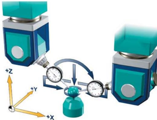
**注意** 作为一个选择方案，测量仪表可以固定在工作台上，也可夹紧在刀具主轴中。
