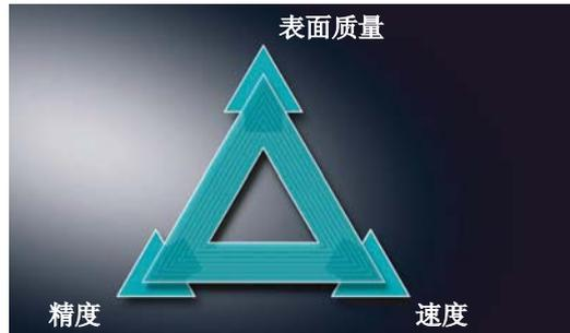
在 CAM 程序中 HSC 范围内，这三种加工类型对精确度和路径轮廓速度有直接关联。通过指定公差值，操作人员/程序员可以相应加权系数。
