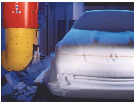
在所有应用领域中，对模具设计标准的要求日益提高。人机工程学、空气阻力系数或就仅从美学角度也越来越多地要求设计时采用圆形结构。此外，工艺过程也必须更为快捷、更为精确。设计主要源自 CAD 系统，复杂表面的加工程序则来自 CAM 站。
