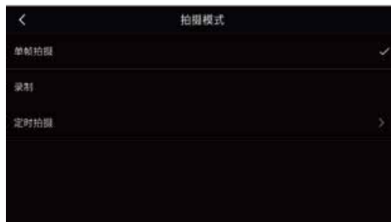
本机全辐射热像视频录制
