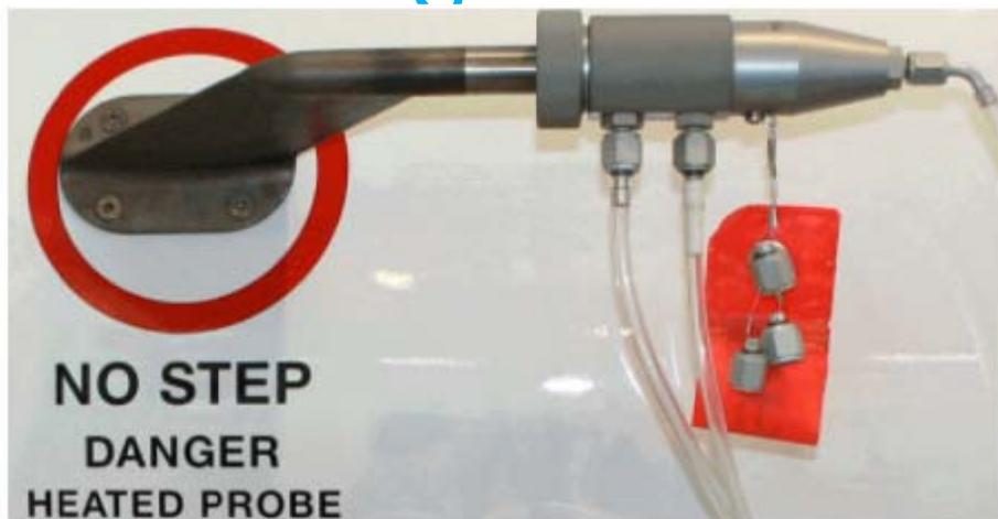
空速管工作原理也与空速管上是否带有风标，即迎角传感器（AOA）和侧滑角传感器(AOS)，此类型空速管主要用来飞机飞行试验的标准空速管，做为飞机上长度较短的空速管主要参考空速管。我们也常常看到有些国外军用飞机上的空速管带有攻角传感器和侧滑角传感器。这种类型空速管的迎角传感器和侧滑角传感器主要原理是电位计和霍尔或RVDT同步器。
