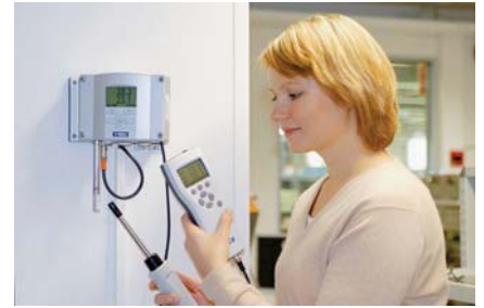
适用于现场检查 HMT330 变送器的手持式湿度和温度仪表 HM70。
